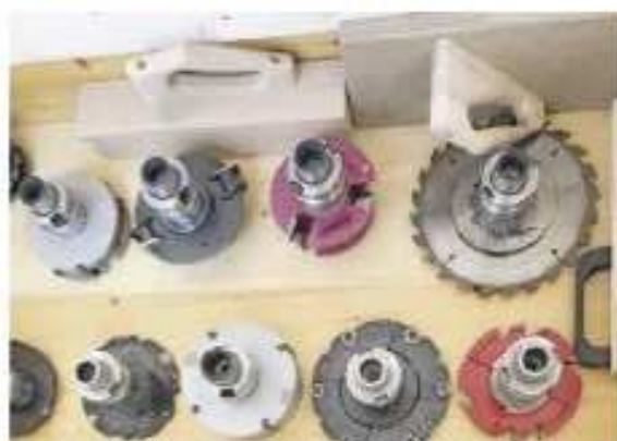
Jedes Werkzeug im Schrank an der Tischfräse sitzt auf einer HSK-Spindel
