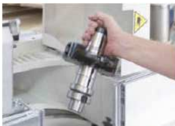
Für den Werkzeugwechsel hat der Schreiner die Spindel über die Steuerung gelöst
