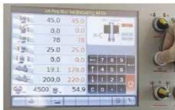
Der Screen zeigt das Werkzeug und alle Einstellungen. Per Taster lässt er alles auf Position fahren
